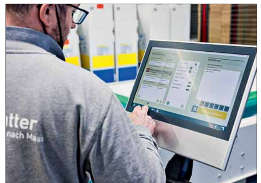
Eingabe, Kontrolle bzw. Übernahme der Auftrags- und Prozessdaten an die Anlagensteuerung
