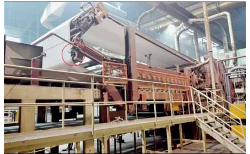
Um die Bandposition zu überwachen, ist jedes der vier Förderbänder mit einer Bahnkantenabtastung ausgestattet (roter Kreis). Fotos: Swiss Krono (2)
