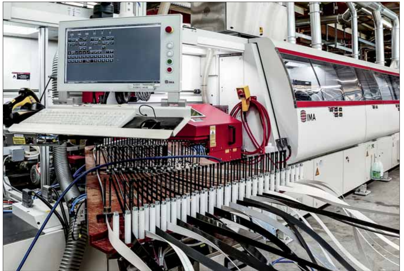
Stöcklin führte als eines der ersten Unternehmen die Lasertechnologie ein und nutzt für die Nullfugen-Bekantung die Kantenbänder von Rehau.
