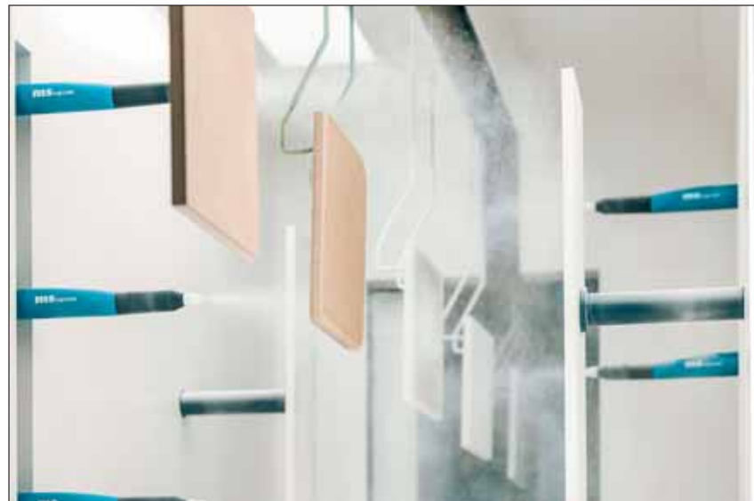
Die Pulverbeschichtung ist ein effizientes Verfahren, weil etliche Arbeitsschritte wie Füllern oder Zwischenschleifen wegfallen.
