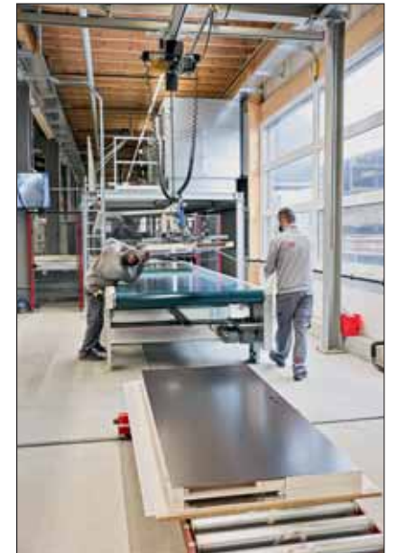
Endkontrolle und Ab stapeln mit Unterstützung von Vakuum-Saugern
