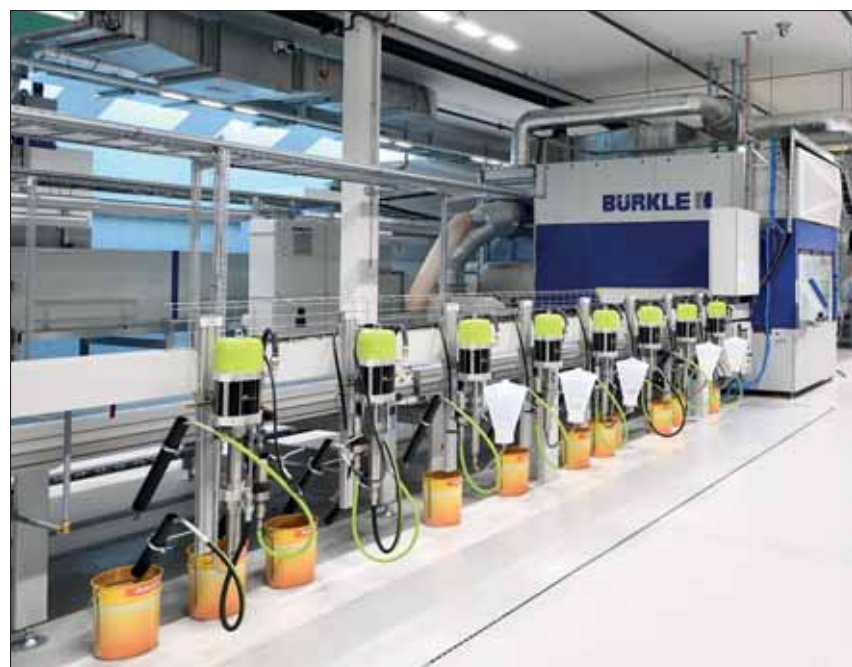
Auf der vollautomatischen Spritzlackieranlage von Riweg werden die „Pigmolux“-Lacke verarbeitet. Fotos: Riweg Türen AG
