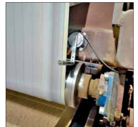
Um die Bandposition zu überwachen, ist jedes der vier Förderbänder mit einer Bahnkantenabtastung ausgestattet (roter Kreis). Fotos: Swiss Krono (2)
