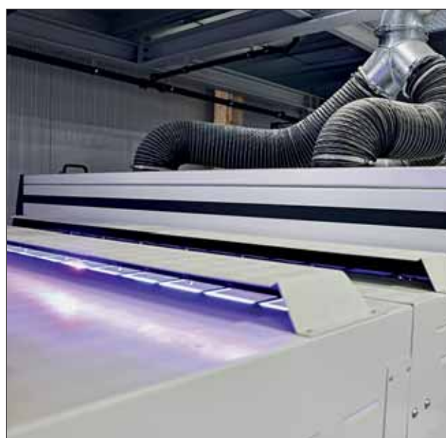
UV-Trocknung für eine schnelle Aushärtung der obersten Lackschicht
