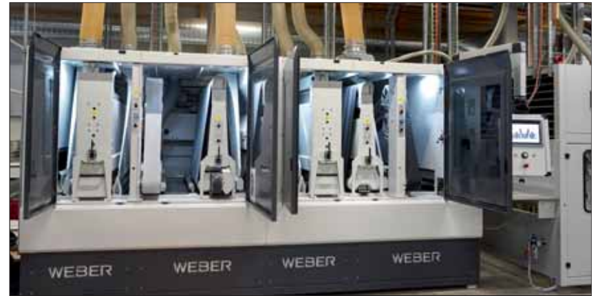
Die „KSF“ mit ihren sechs Schleif- und Bürstenaggregaten
