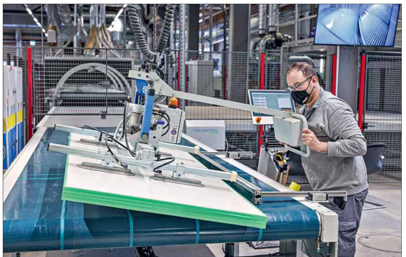
Vakuumsaugheber unterstützen das Fachpersonal beim Handling schwerer Türen: Auflagen auf die Transporteinrichtung vor dem Einlauf in die Venjakob-Anlage.
