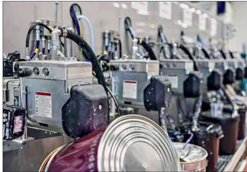
Vollautomatisch gesteuertes Lackmanagement bei RWD Schlatter: Direkt an der Anlage platziert, erlaubt es kurze Leitungswege, geringe Lackverluste und schnelles Umrüsten.
